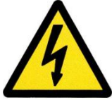
Pericolo tensione elettrica
